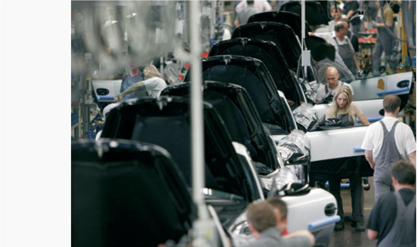
beginnt. Der Motorentransport erfolgt über neuartige, magnetgesteuerte fahrerlose Transportsysteme. Das Material wird über Rollwagen und Elektroschleppzüge ohne Gabelstapler bereitgestellt, was zu einer Beschleunigung der Teileversorgung beiträgt. Auch die Bereitstellung der Materialien an den Montagebändern wurde optimiert. Zudem wurde in das neue Werk die Fertigung von Motoren-Prototypen für neue Modelle integriert, in deren Rahmen auch Mitarbeiter geschult werden.
